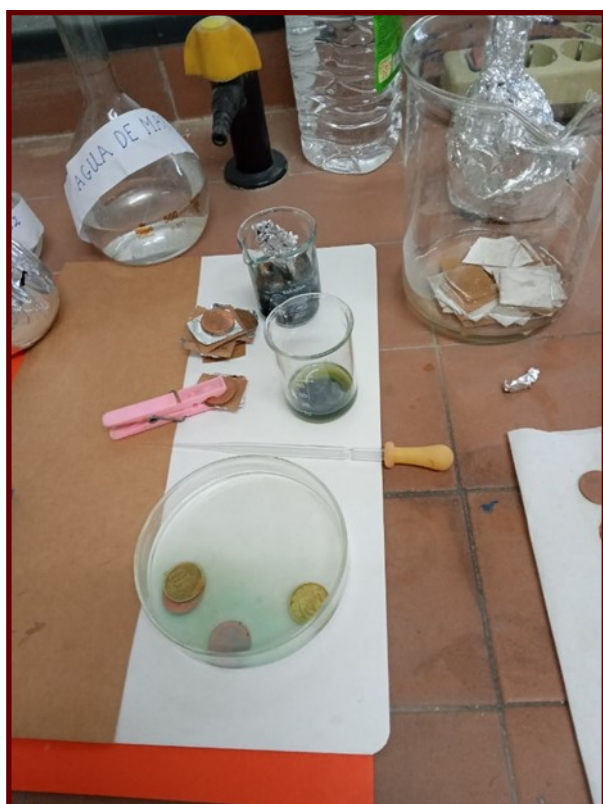
Figura 5. Algunos ensayos químicos con monedas de composición conocida. Se observa en la placa Petri que la sal de mesa disuelta al 3.5% ("Agua de Mar") se colorea de azul a los dos días en presencia de monedas de 5 céntimos (recubiertas de cobre). La diferencia de potencial de la pila moneda de 5 céntimos/cartulina impregnada de "Agua de Mar"/papel de aluminio, sujeta por una pinza, es superior a 1.5 V. El papel de aluminio en un vaso de precipitados "se deshace" exotérmicamente en medio suficientemente ácido. Las monedas se limpian sumergidas en vinagre de limpieza. Los colores de las superficies de las monedas sumergidas en líquidos cambian con el tiempo....
